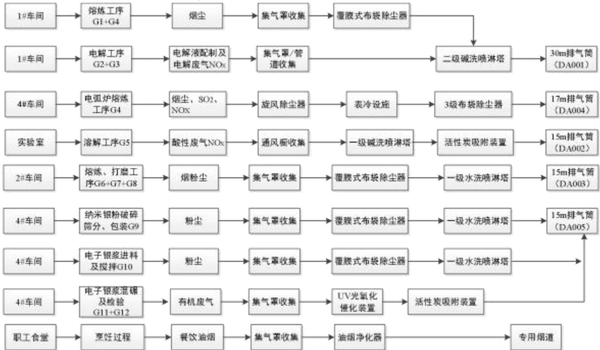
图 3-6 项目废气处理工艺流程图
