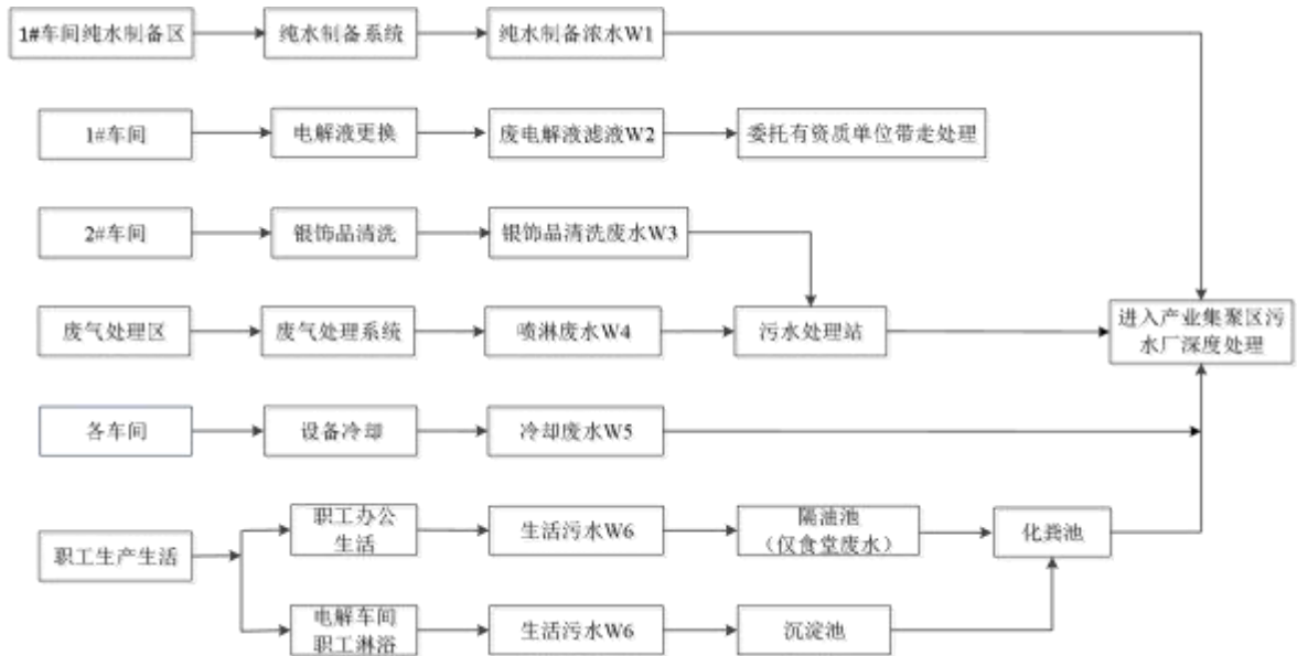
图 3-7 项目废水处理工艺流程图
